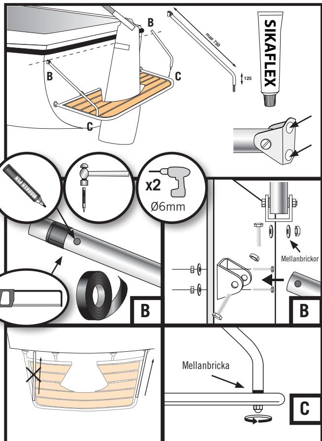
4: Mät ut stagens längd mot akterspeglar. Tejpa runt staget och kapa med bågfil. Markera först med spritpenna och sedan med körnare var u-beslaget skall fästas i staget. Borra därefter nya hål. Fäst u-beslagen och markera med penna direkt i hålen på u-beslagen där fästhålen skall borras i akterspeglar. Stagen bör följa plattformens linje utåt eller aningen utanför.
