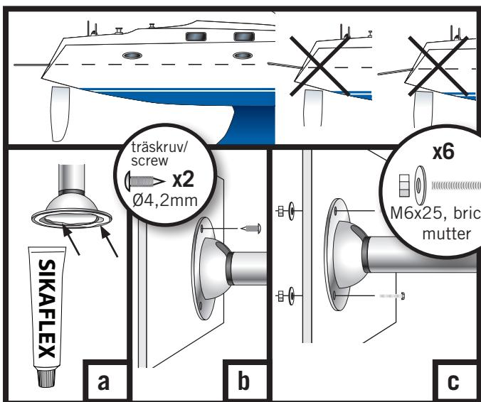
**3:** Fäst plattformen provisoriskt med en självgående skruv (a) i ett av hålen, fixera plattformen mot akter med hjälp av lina i pulpit. Flukta linjen mot skrov och däck så att plattformen hamnar rakt. Fäst universalbeslagen med bultar (b) i skrovet. Ta bort skruven (a) och fäst sista bulten i varje beslag. Täta med Sikaflex.
