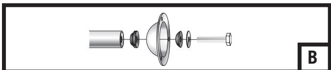
**1:** Kontrollera att alla delar finns med. Fäst universalbeslagen på plattformen. Skruva fast lagom så att de kan justeras mot akterspeglens.
