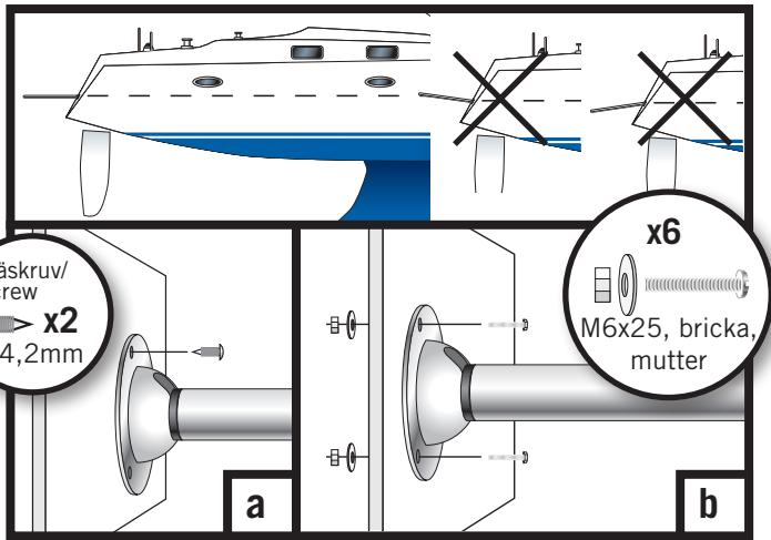
3: Fäst plattformen provisoriskt med en självgående skruv (a) i ett av hålen, fixera plattformen mot akter med hjälp av lina i pulpit. Flukta in linjen mot skrov och däck så att plattformen hamnar rakt. Fäst universalbeslagen med bultar (b) i skrovet. Ta bort skruven (a) och fäst sista bulten i varje beslag. Täta med Sikaflex.
