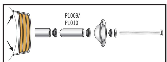
Förlängning + 50 mm finns att beställa. P1009 ( $\varnothing 25$  mm), P1010 ( $\varnothing 32$  mm). Eventuellt måste stagen(B) under plattformen bytas till ett längre (vid rak akter). Finns att beställa: P1032 (350 mm).
