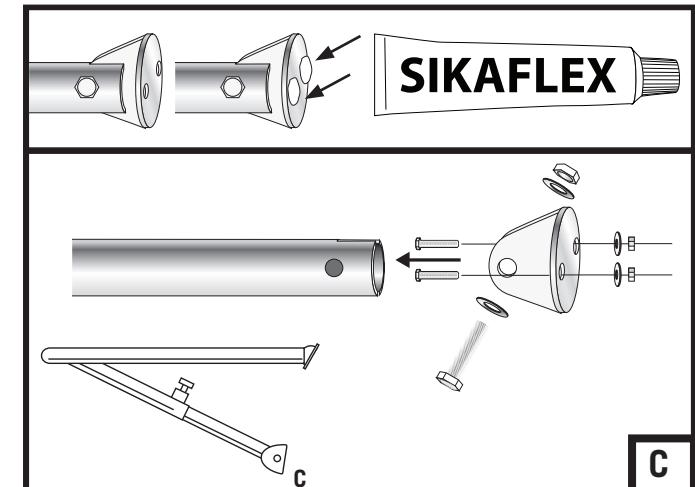
4: Fäst u-beslagen och markera med penna direkt i hålen på u-beslagen där fästhålen skall borras i akterspeglens. Skruva åt teleskopstagen ordentligt.
