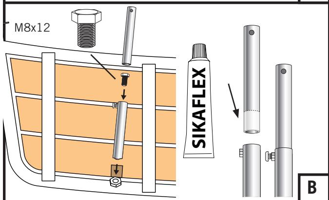
1: Kontrollera att alla delar finns med. Fäst universalbeslagen på plattformen. Skruva fast lagom så att de kan justeras mot akterspegeln. Fäst teleskopstagen under plattformen
