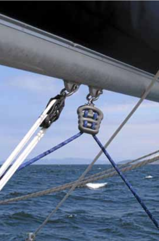
Ofrivilliga gippar kan orsaka allvarliga skador på både båt och besättning. Familjen Hammarberg har minimerat risken med hjälp av bombromsar från Wichard.
