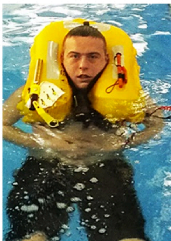
8 av 10 flytvästar håller inte upp munnen tillräckligt högt över vattenytan. Foto: Fleetwood Testing Laboratory
