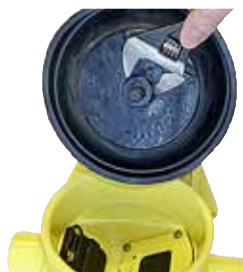
Steg 3 – Lösgör muttern som håller membranet genom att dra den motsols med skiftnyckel eller en 22 mm nyckel.
