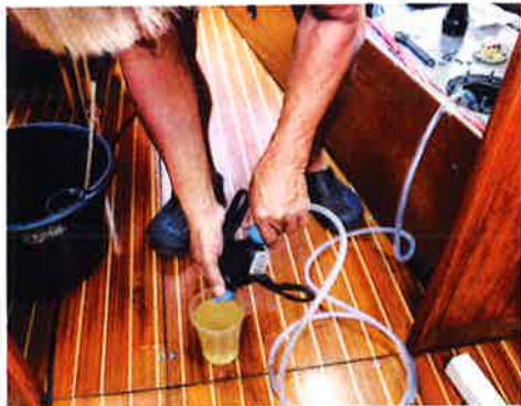
En simpel pumpe er tilstrækkelig til at tappe dieselprøven fra båden.
