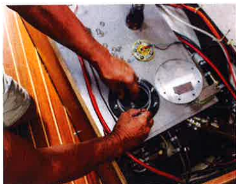
Inspektionslugen er nødvendig, når dieseltanken skal checkes indvendigt før hver sæson.
