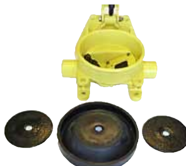
Steg 4 – Tag bort membranets skivor och själva membranet.
