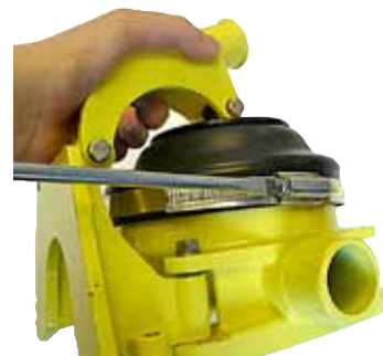
Steg 1 – Slacka och avlägsna slangklämman för att frigöra membranet. Använd en vanlig flat skruvmejsel eller (helst) en slangklämskruvmejsel.
