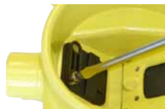
Steg 5 – Ersätt de gamla insugs- och utsläppshälen genom att skruva loss dessa och montera nya delar. Både insug och utsläpp har likadana delar. Försäkra dig om att de kommer på helt rätt plats.
