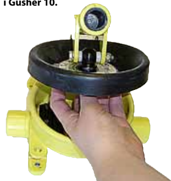
Steg 6 – Montera nytt membran och placera detta med den "mjuka" sidan nedåt.
