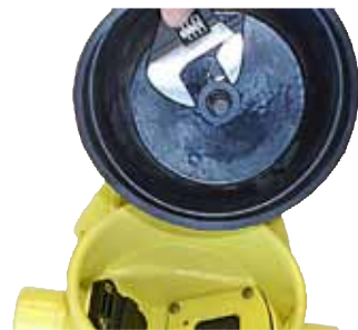
Steg 7 – Ersätt membranets mutter. Dra den medsols tills den håller tätt. Kolla så att membranets baksida blir plant monterat och sluter helt tätt.
