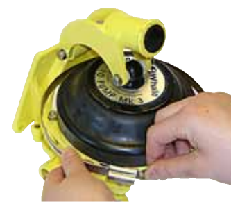
Steg 9 – Kolla slutligen att pumpens ytskikt är OK. Annars bör du bättra med lite färg. Efter det återstår bara att montera tillbaka den i båten.
